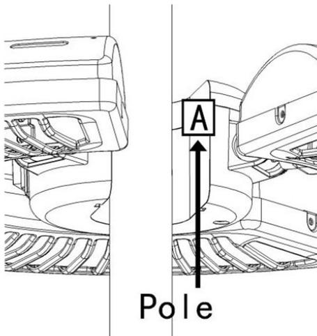
**Vaihe 2:** Työnnä asennusosa (osa B) keskiosan A alaosaan olevaan uraan (kuten kuvassa)
