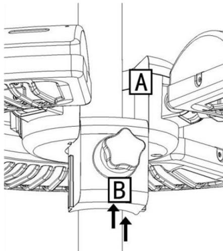
**Steg 3:** Vrid på fingerskruven tills terrassvärmaren är fastspänd på stängen.
