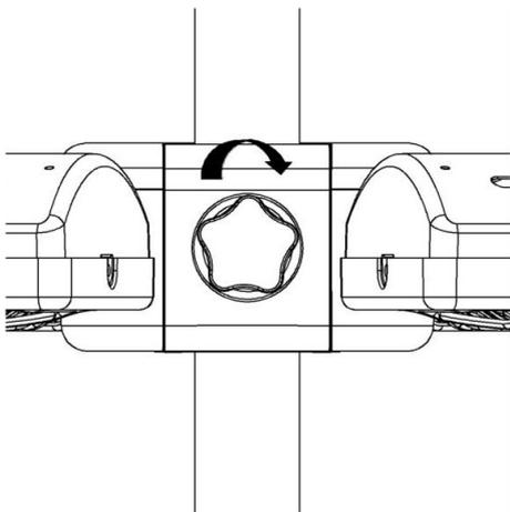
**Vaihe 4: Terassilämmittimen moduulit voidaan säätää kolmeen eri asentoon.**
