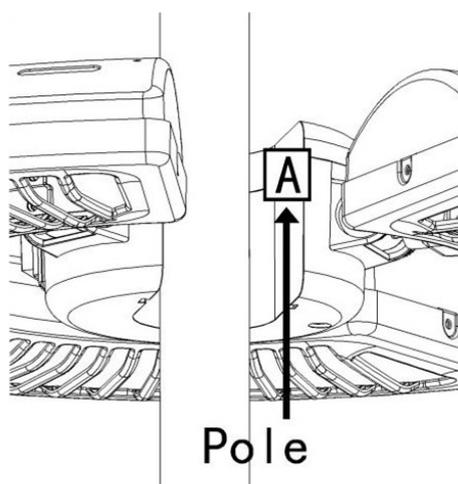
**Step 2:** Skub monteringsdelen (del B) ind i slidsen forneden på del A (som vist på tegningen).
