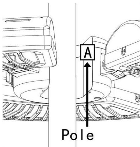
**Steg 2:** Skjut in monteringsdelen (del B) i spåret nederst på del A (som visat på teckningen).
