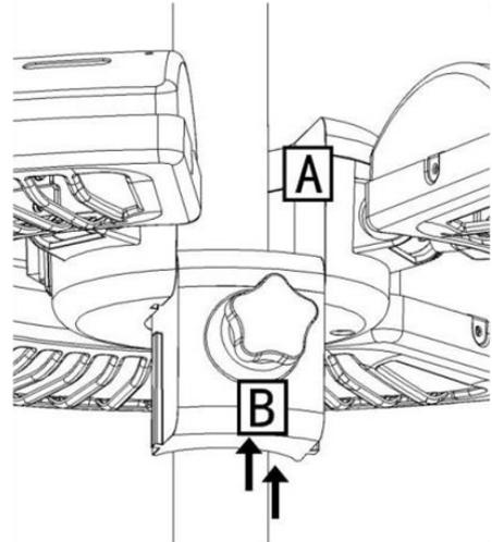
**Vaihe 3:** Kierrä peukaloruuvia, kunnes terassilämmitin on kiinnitetty tankoon.
