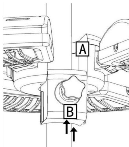
**Step 3:** Drej på fingerskruen indtil terrassevarmeren er spændt fast på stangen.
