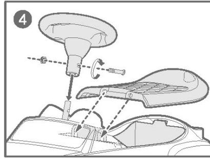
Liitä ratti tankoon ja kiinnitä nämä 2 osaa toisiinsa ruuvilla ja mutterilla. Asenna istuin paikalleen.
