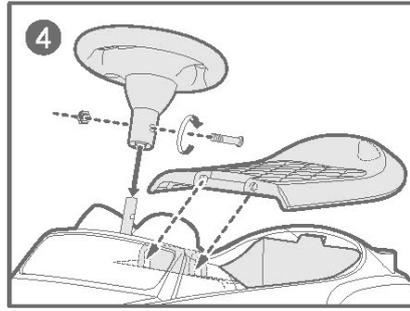
Sätt ihop ratten med rattstammen och fäst de två delarna med skruv och mutter. Installera sätet på karossen.
