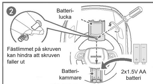
Öppna batteriluckan på ratten. Sätt i två AA-batterier i batterikammaren. Sätt på luckan igen och spänn åt skruven.
