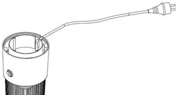
Steg 3: Sätt på locket igen och fäst det genom att vrida det medurs.
