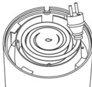
Vaihe 2: Ohjaa virtajohto ulos muovirungosta rungon sivussa olevan reiän kautta.
