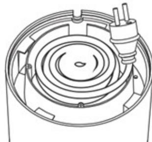
Step 2: Træk ledningen ud af foden og før ledningen igennem hullet i siden på terrassevarmeren.
